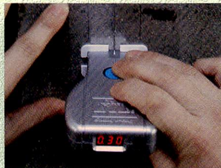
2. 次に Marking Sheet の白い枠に合わせて Crack EYE をセットし、Crack EYE のボタンを押します。Crack EYE に測定結果が表示されます。
