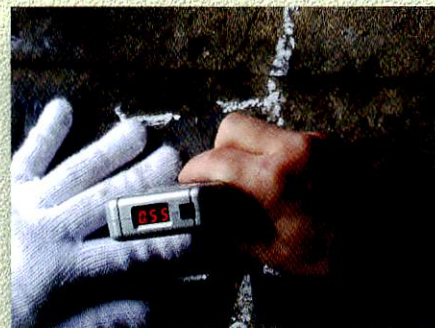
2. 次に Marking Sheet の白い枠に合わせて Crack EYE をセットし、Crack EYE のボタンを押します。Crack EYE に測定結果が表示されます。
